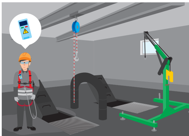
Rysunek 4. Stałe monitorowanie przyrządami kontrolno-pomiarowymi w pomieszczeniu krat
